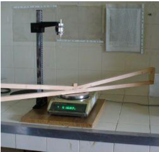
Foto 1 - 2 - 3 - 4 - 5 : il momento della misura del peso del modellino strutturale
